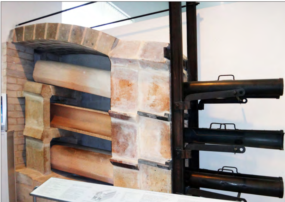
Modell eines Teils eines Muffelofens im Deutschen Museum in München. Hier sind die Muffeln in drei Lagen angeordnet. In Belluna lagen alle 28 Muffeln auf gleicher Höhe.
