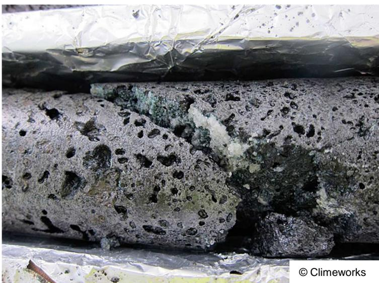
Abb. 4.1.5: Basaltgestein (dunkelgrau) mit dem neugebildeten, weissem Kalkmineral (Calcit). (Photo: Sandra O Snaebjornsdottir)
