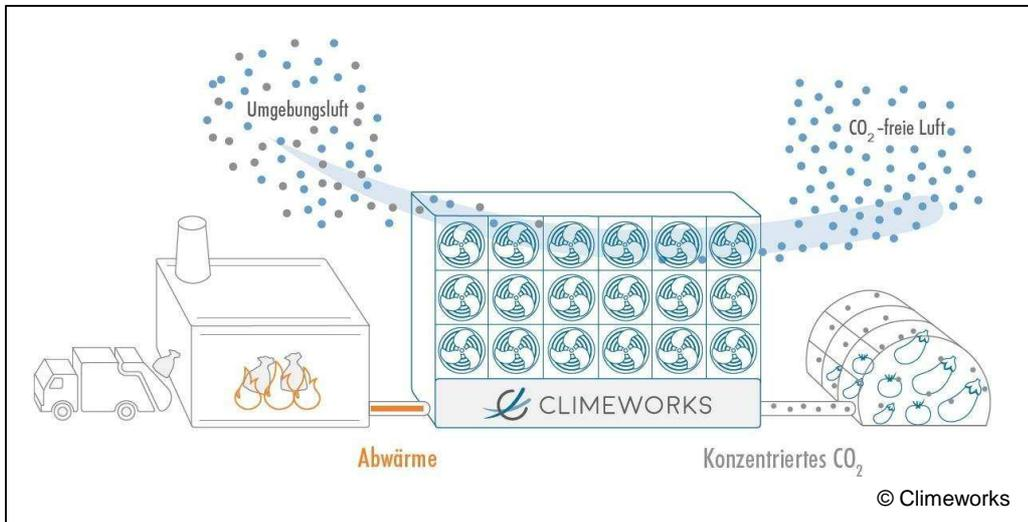
Abb. 4.1.2: Das Funktionsprinzip der Climeworks-Anlage: Die Ventilatoren saugen Luft in den Kollektor, wo das CO<sub>2</sub> herausgefiltert wird.
